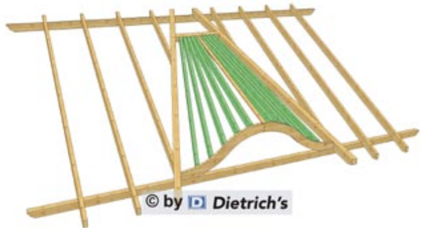
Rys. 8. Schemat konstrukcji lukarny wariant 2B – deska czołowa + krokwie.
