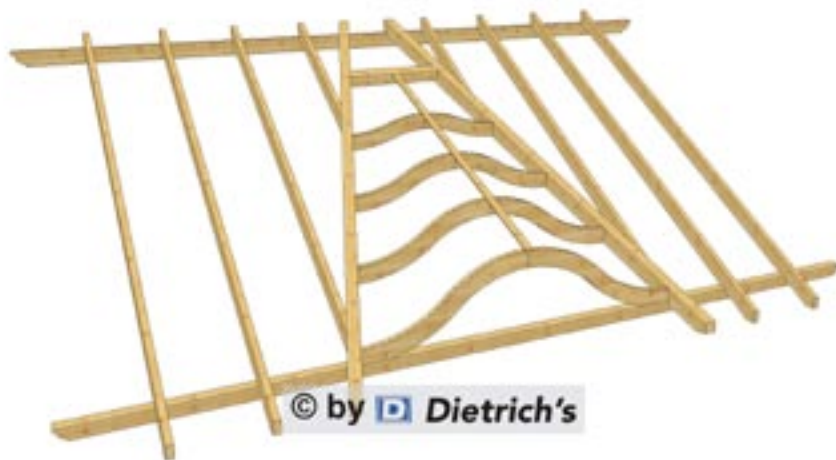
Rys. 5. Schemat konstrukcji lukarny wariant 2B – krążyny + krokwie koszowe.
