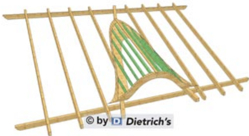
Rys. 5. Schemat konstrukcji lukarny wariant 1B – deska czotowa +krokwie + deski koszowe.
