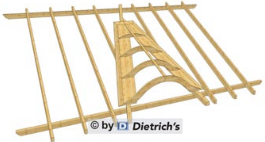
Rys. 7. Schemat konstrukcji lukarny wariant 2B – krążyny + deski koszowe.
