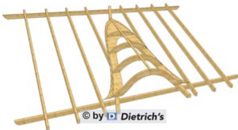
Rys. 4. Schemat konstrukcji lukarny wariant 1B – krążyny + deski koszowe.
